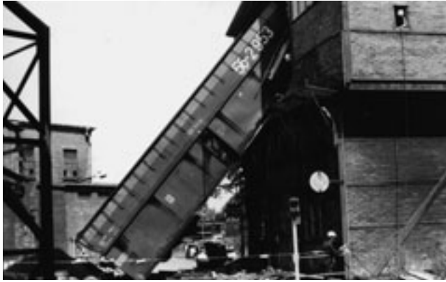
Abb. 7-8-12: Überfahren eines Gleisabschlusses in der Brikkettfabrik Lobstädt vom 10.07.1987 (Foto: Archiv Bergamt Borna)
