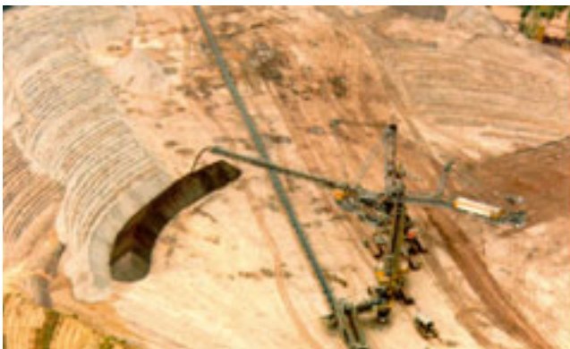
Abb. 5-2-57: Kulturbodenauftrag mit Bandabsetzer 1115 A 2 Rs-B 10000.110 im Tagebau Espenhain
