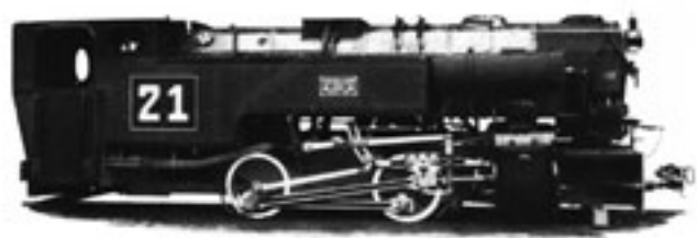
Abb. 4-5-7: „B“-Nassdampf-Tenderlokomotive mit Einsatz ab 1929 in den DEA-Tagebauen der Oberbergdirektion Altenburg (Foto: Archiv BRÄUTIGAM)
