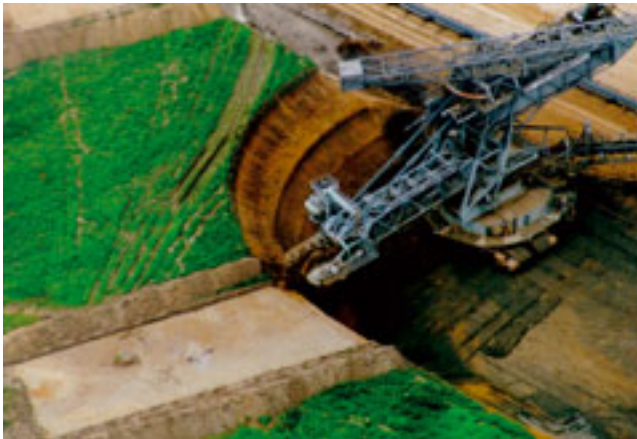
Abb. 5-2-48: Bagger 1522 SRs 1300 im Blockverhieb
