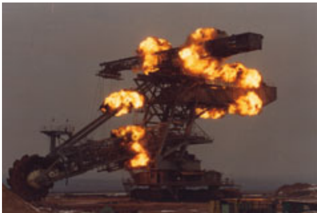
Abb. 7-8-17: Sprengung des Baggers 1522 SRs 1300 im Tagebau Zwenkau vom 12.02.1999 (Foto: Archiv Bergamt Borna)
