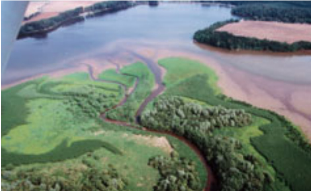
Abb. 3-3-10: Talsperre Windischleuba – Stauwurzel mit Deltabildung (Foto: BERKNER)
